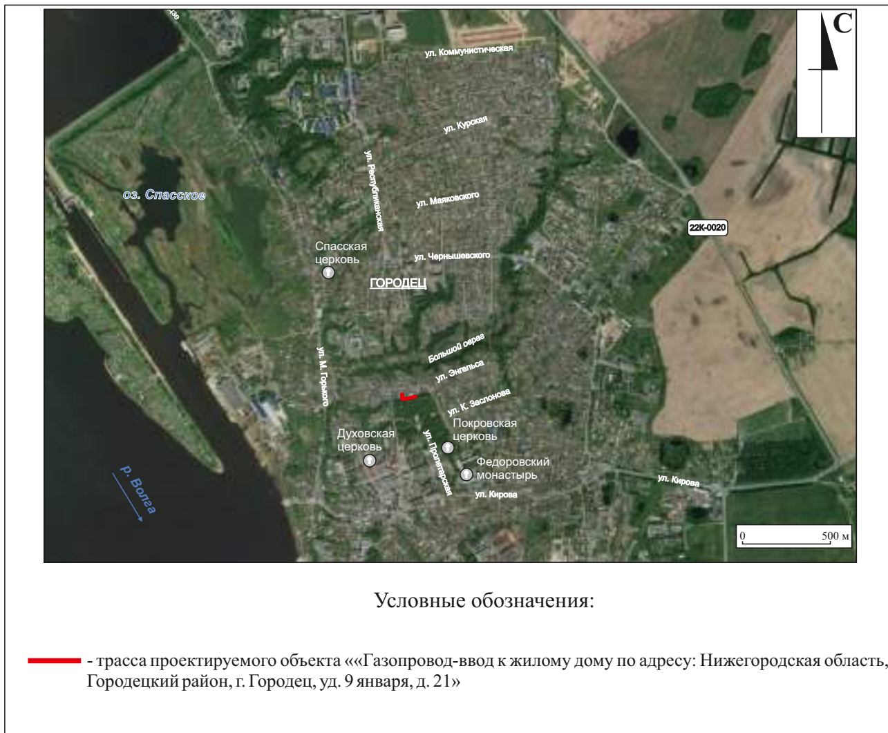
Илл. 5. Космоснимок центральной части г. Городец Нижегородской области с указанием расположения трассы проектируемого объекта «Газопровод-ввод к жилому дому по адресу: Нижегородская область, Городецкий район, г. Городец, ул. 9 Января, д. 21»
